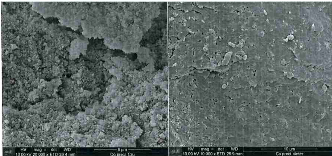
Figura 20: MEV das superfícies de fratura de pastilhas de pó CP1000, a verde (esquerda) e sinterizado a 1400°C (direita)
